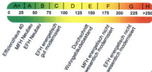
Die modellhaft ermittelten Vergleichswerte beziehen sich auf Gebäude, in denen Wärme für Heizung und Warmwasser durch Heizkessel im Gebäude bereitgestellt wird.
